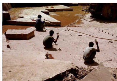
manueller Abbau des Sandsteins
